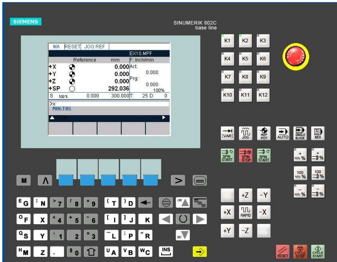
Gambar 1.3. Panel kontrol Mesin Frais CNC: (a) papan ketik CNC, (b) panel kontrol mesin, dan (c) layar
